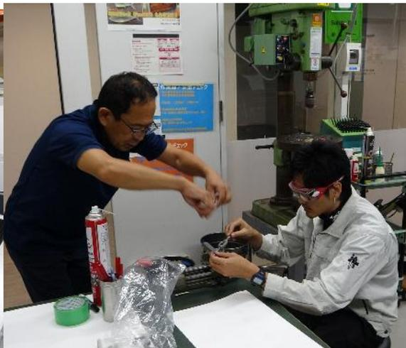
図12. ボール盤加工→タップ切り加工
