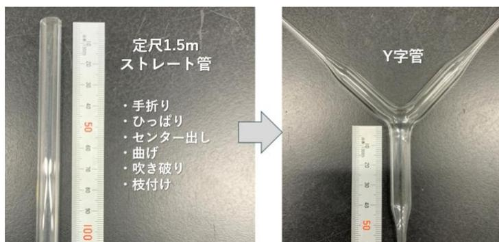
図2. ストレート管とY字管
