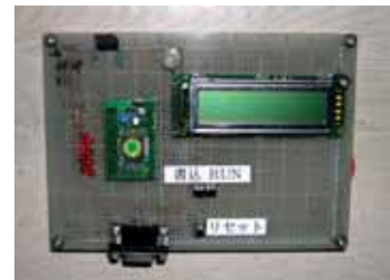
写真 2. PIC による I/O 増設ボード
