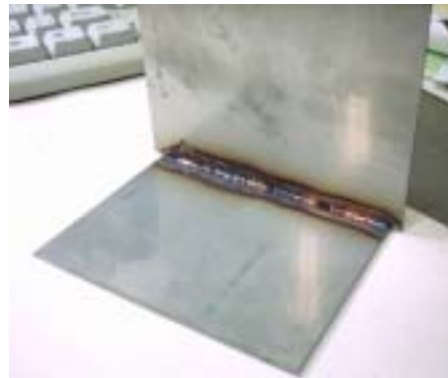
写真3．平板二枚90度谷間溶接
