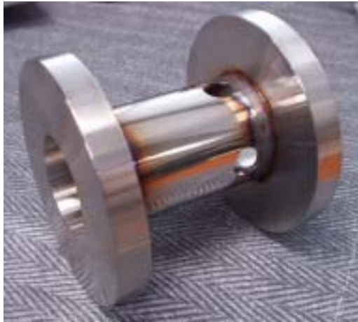
写真6 . フランジダミーパーツの溶接
