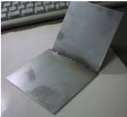
写真2．平板二枚30度谷間溶接
