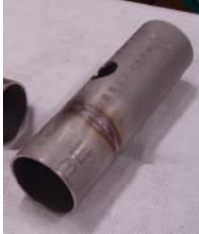
写真4 . パイプ単純突合せ溶接
