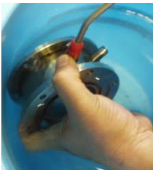
写真.10 バケツ水とコンプレッサーによる簡易水漏れ検査
