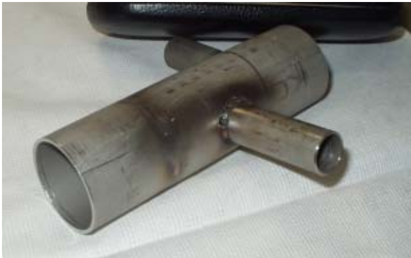
写真5 . 外径38mmパイプの横に16mmパイプを接合溶接
