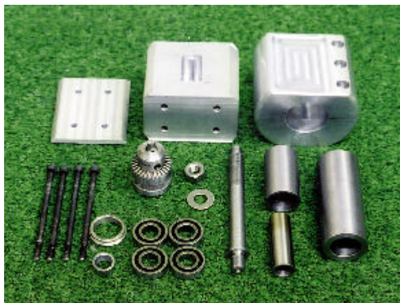
図 1 主軸まわり部品写真
