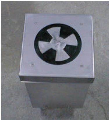
写真1 製作した電界計センサ部の外観
