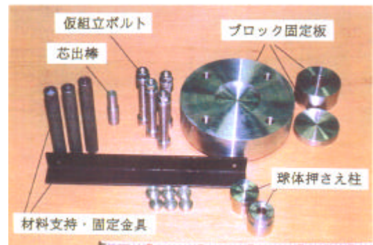
図 3 考案・製作した各種治具
