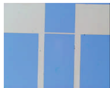
図9 ライン幅2.0 μmの超伝導線
