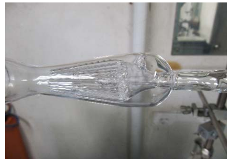
図 12. 外管の取付け後
