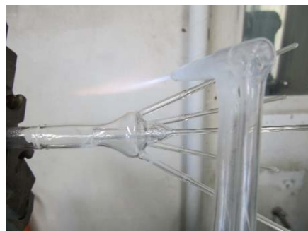
図 6. 酸素ノズル取付け
