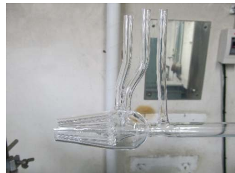
図 13. 外管の切断後
