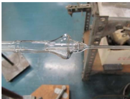
図 5. 中央酸素ノズル取付け
