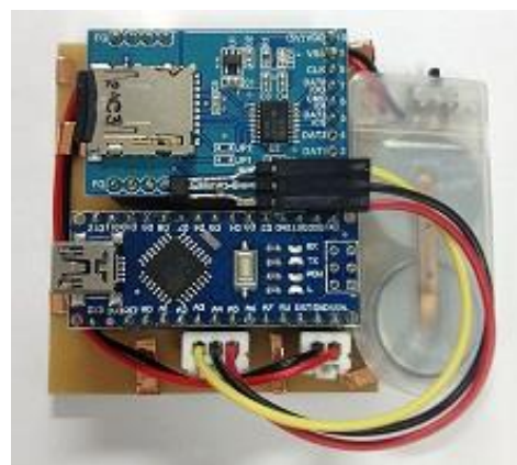
図 1. 作製した磁束密度測定器 (71 mm×59 mm×19 mm)
