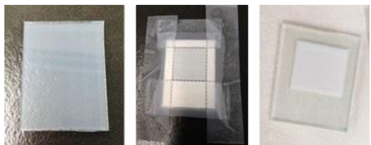
図4 (a) 導電性ガラス (b) スキージ法による塗布準備 (c) \text{TiO}_2 ペースト塗布、焼成後
