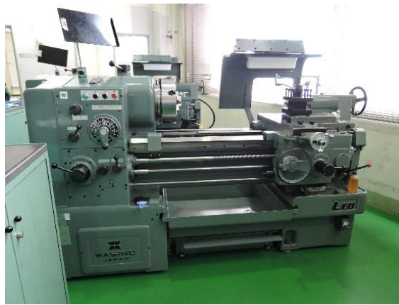
図 1.アマダワシノ製普通旋盤(LEO-80A)
