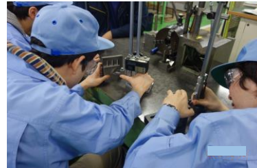
図11 けがき作業(穴あけ部)
