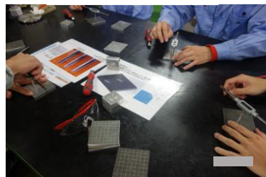
図13 ネジ加工(M6タップ)
