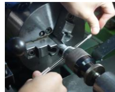
図8 ネジ切り加工
