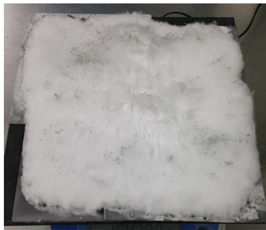
図 2 AIN ウィスカーの析出の様子
