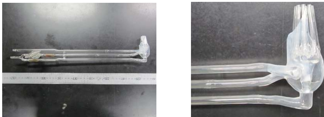
図1. 破損したバーナー（全体・拡大）
