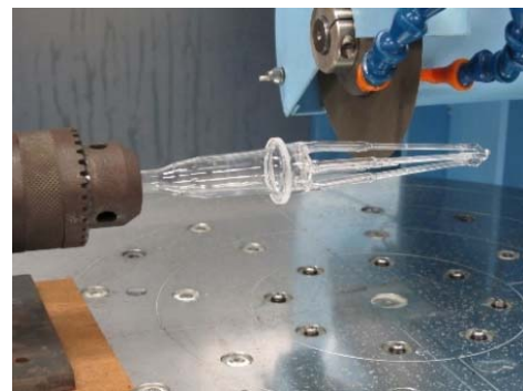
図 5. 酸素ノズルの切断
