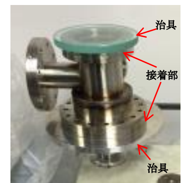
図 15. シール材により接着
