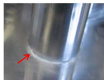
図 13. 電解液の除去不足
