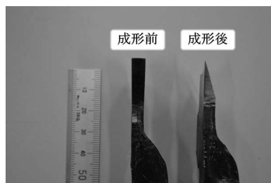
図 5 くびれ部分の荒加工用刃物
