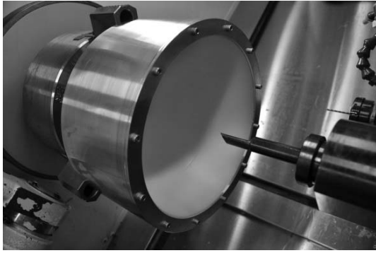
図 11 治具と材料が滑る不具合
