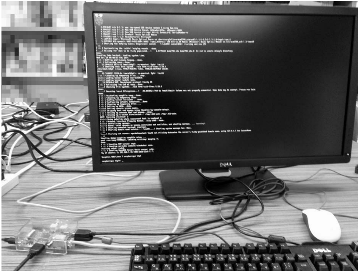
図 2. Raspberry Pi にキーボード、マウス、モニターとネットワークを接続し起動した画面
