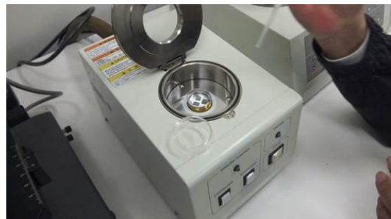
写真3 凍結乾燥機への試料のセットの仕方
