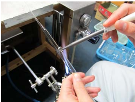
図 6 カーボンのコテでの整形
