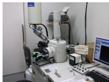
写真-1：日立 FE-SEM (S-4800) 型 写真-2：日本電子 6610A 型 写真-3：日立 SEMEDX-TypeH
