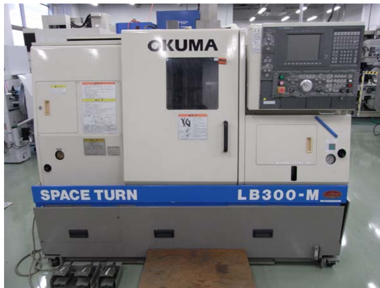
図 1 装置開発技術系装置開発ファクトリーに導入されている CNC 旋盤
