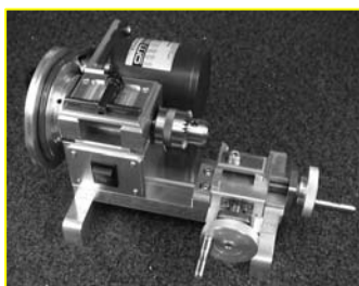
図1. 汎用ミニ旋盤
