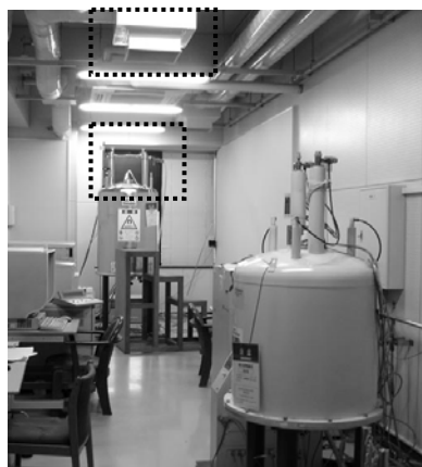
図1 NMRの安全装置（左の写真はNMR本体に設置してあるセンサー、定置型の酸欠事故防止用検知警報器に連動させるより早く作動する。このセンサーが温度を感知することにより右の写真の枠で囲ってある非常用換気装置が停電時でも作動する仕組み。）
