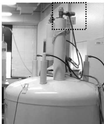
図1 NMRの安全装置（左の写真はNMR本体に設置してあるセンサー、定置型の酸欠事故防止用検知警報器に連動させるより早く作動する。このセンサーが温度を感知することにより右の写真の枠で囲ってある非常用換気装置が停電時でも作動する仕組み。）
