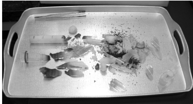
図 1. 破損した燃焼管
