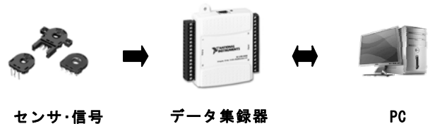
図1 最近の PC ベースの計測システム
