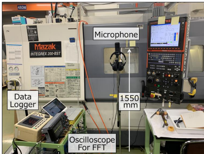
図2 使用した機械とマイクの設置位置
