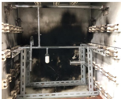
図 6. ヨウ素封入用ガラスライン
