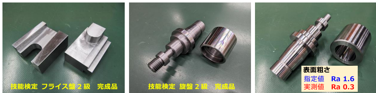
図 11. フライス盤課題(左)、旋盤課題(中)、旋盤課題表面粗さ追求品(右)
