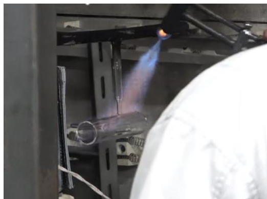
図 8. 石英製セルのベーキング
