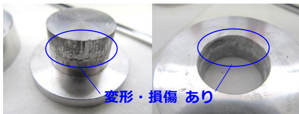
図 25. 旧型打錠機の使用 1 回後
