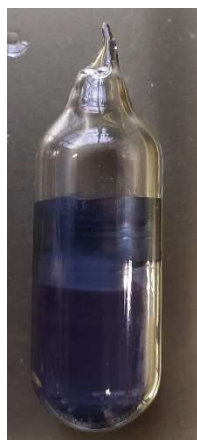
図 11. 不純物が多く含まれる凝縮附着物
