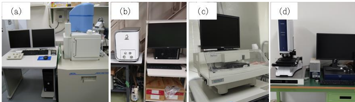
図2-1. 本研修で用いた測定装置 (a)走査電子顕微鏡JSM-6610A (b)走査電子顕微鏡JCM-6000plus (c) 段差計Alpha-Step IQ (d) 共焦点顕微鏡OPTELCIS HYBRID+C3
