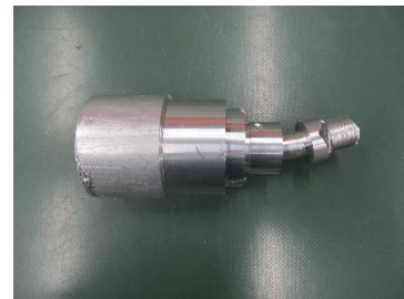
図 9. チャックから脱落实破損
