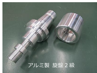
図 10. アルミ材料を用いた全体製作
