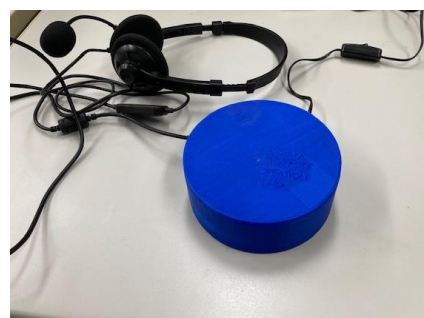
簡易 AI スピーカー外観 (パッケージは 3D プリンターにて作製)
