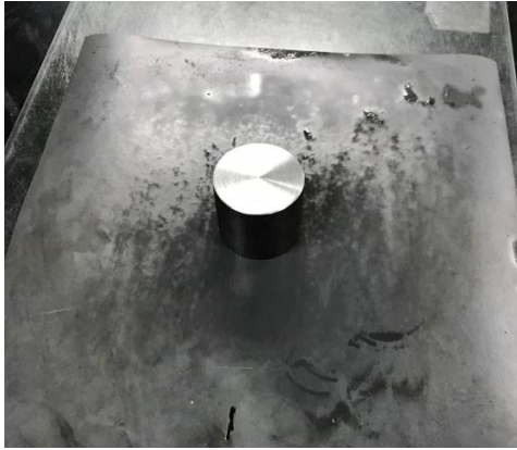
図 3. ペーパー仕上げの様子
